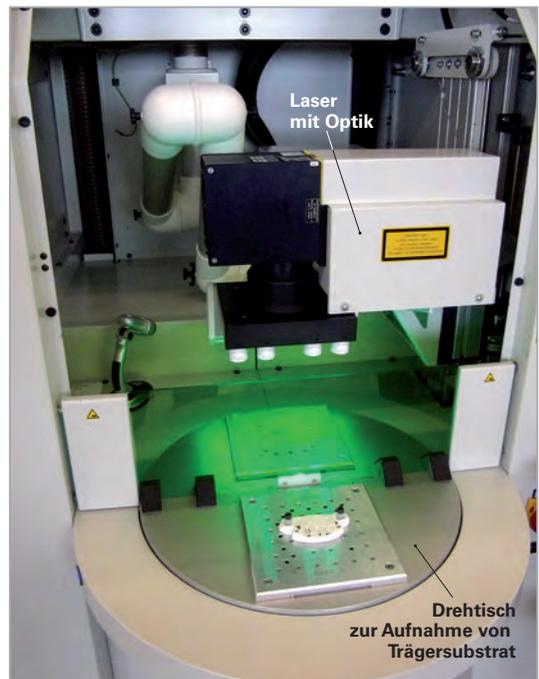
**Bild 3: Blick in den Arbeitsraum einer LDS-Anlage**
