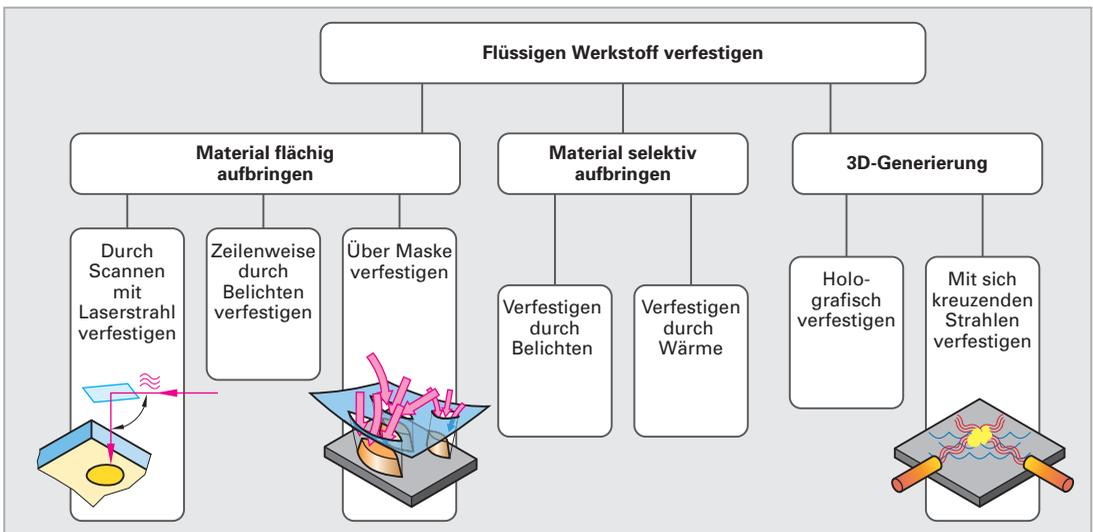
**Bild 1: Vom flüssigen Zustand des Werkstoffs ausgehend verfestigen**
