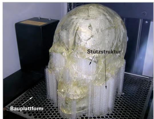
**Bild 3: Feste Verbindungen mit der Bauteilplattform**
