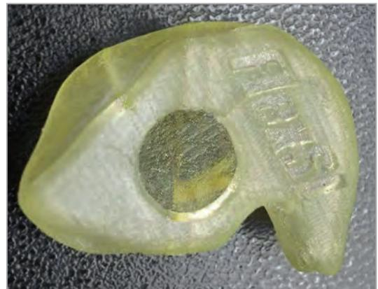
**Bild 3: Im Stereolithographieverfahren hergestellte Gehörkapsel**
