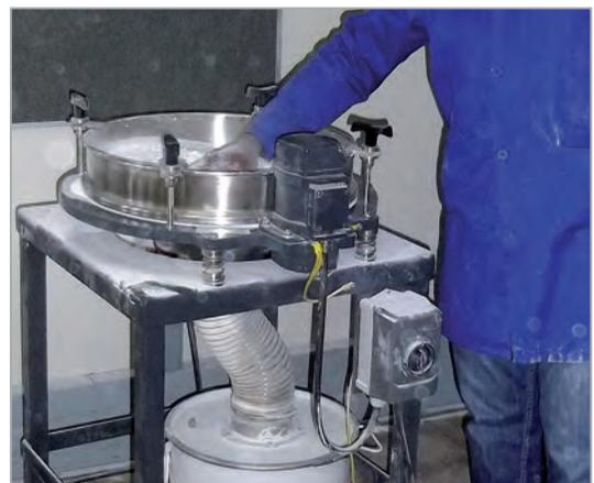
**Bild 3: Kunststoffpulveraufbereitung in Siebstation**
