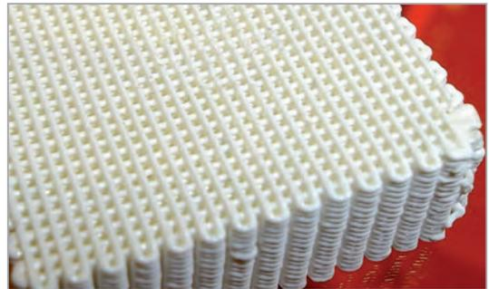
**Bild 3: Scaffold, Stützwerk für Knochensubstanz in der regenerativen Medizin**
