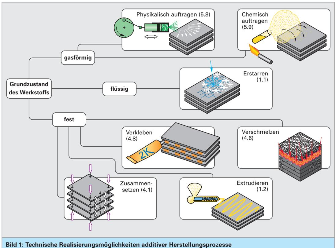
**Bild 1: Technische Realisierungsmöglichkeiten additiver Herstellungsprozesse**
