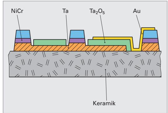
**Bild 2: Beispiel einer Dünnschichtschaltung in der Elektronik**
