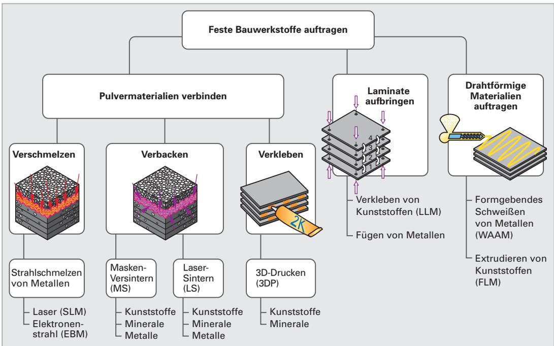
**Bild 2: Vom festen Zustand des Werkstoffs ausgehend auftragen**
