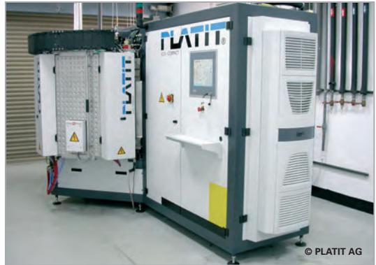
**Bild 2: PVD-Beschichten mit Sputter-Anlage**
