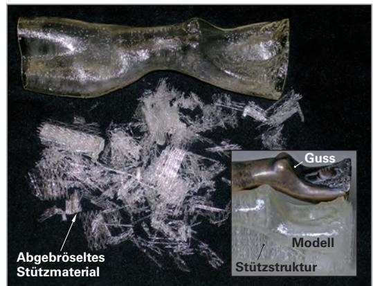
**Bild 2: Entfernen der Stützstruktur**
