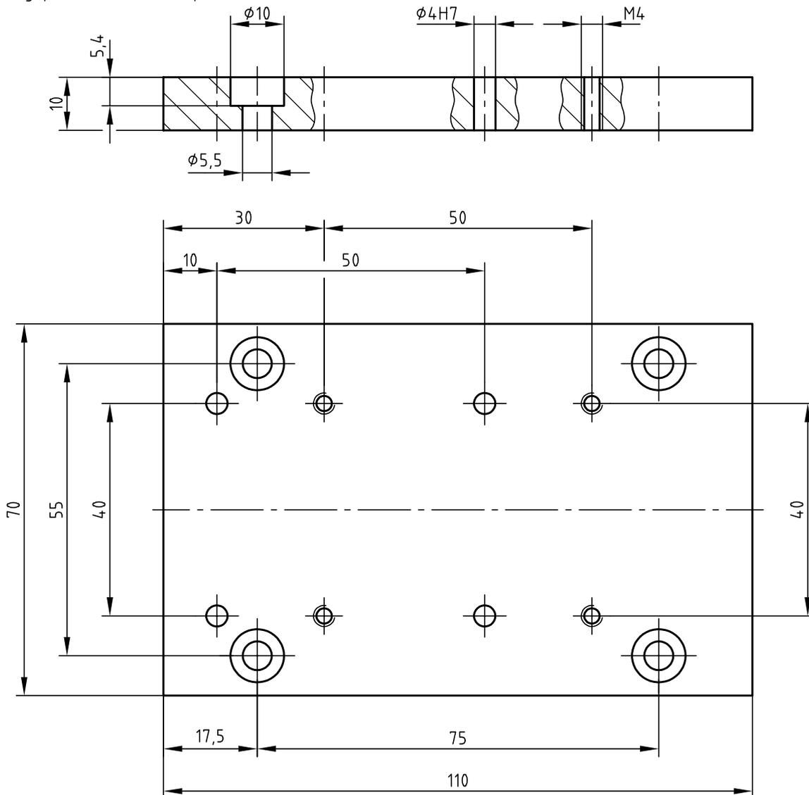
Die Adapterplatte ist zusammen mit den Führungsleisten 1 und 2 zu fertigen.
