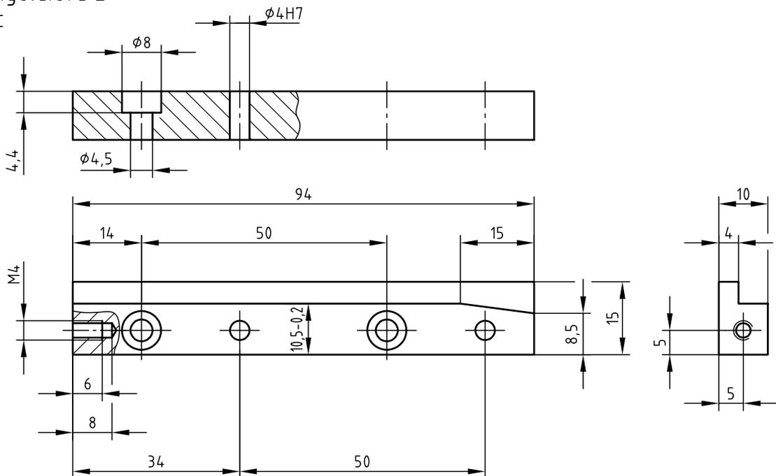
Die Führungsleisten 1 und 2 sind zusammen mit der Adapterplatte zu fertigen.
