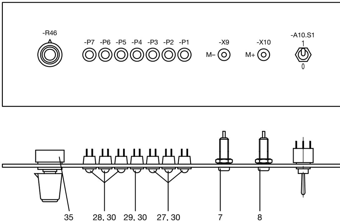
Die Positionsnummern beziehen sich auf die Seiten 4 und 5. Die Maße „X“ richten sich nach den verwendeten Bauelementen. Die Bauelemente in der Frontplatte dürfen, bis auf -A10.S1, nicht vorverdrahtet werden. Die Zeichnungen sind nicht maßstabsgerecht.
