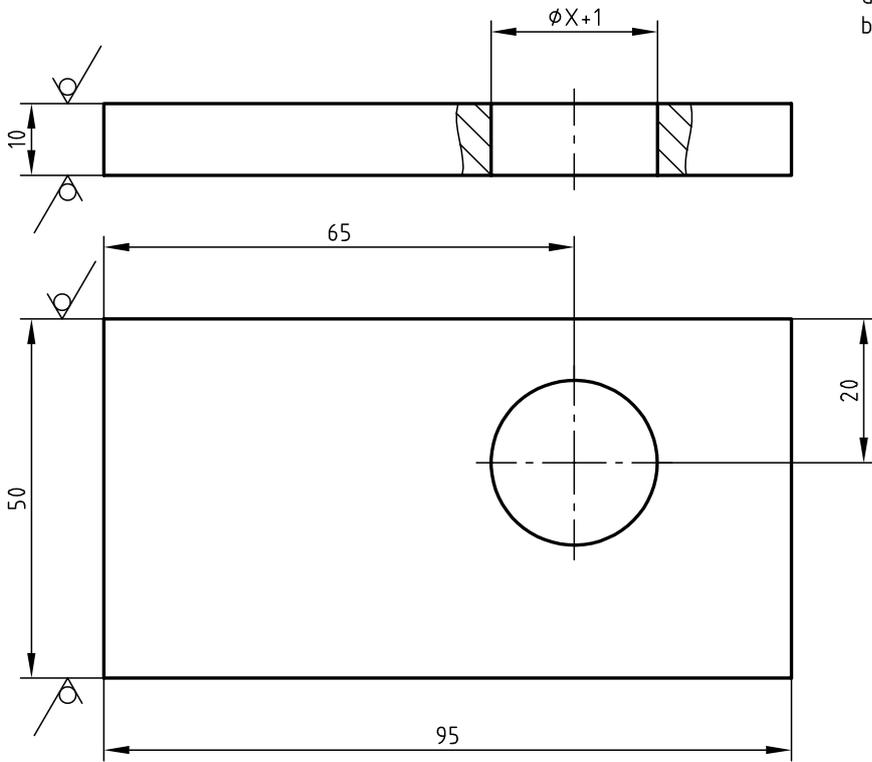
$\phi X+1$  = Gewinde-Nenndurchmesser des Befestigungsgewindes von dem bereitgestellten Zylinder +1 mm
