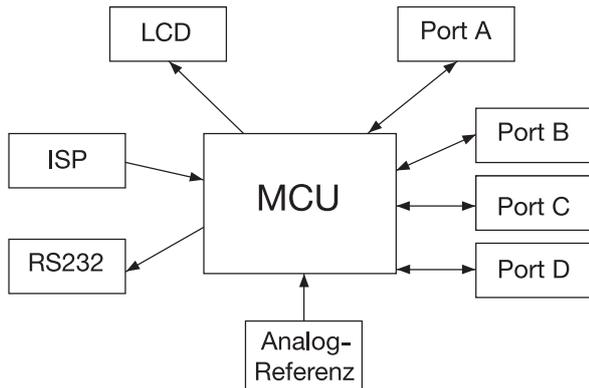
Bild 1: Blockschaltbild Mikrocontroller-Leiterplatte
