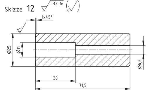
Für die Oberflächenbeschaffenheit der Bohrungen, Senkungen und geriebenen Bohrungen gilt der mit dem Fertigungsverfahren bei fachgerechter Anwendung erreichbare Endzustand.
