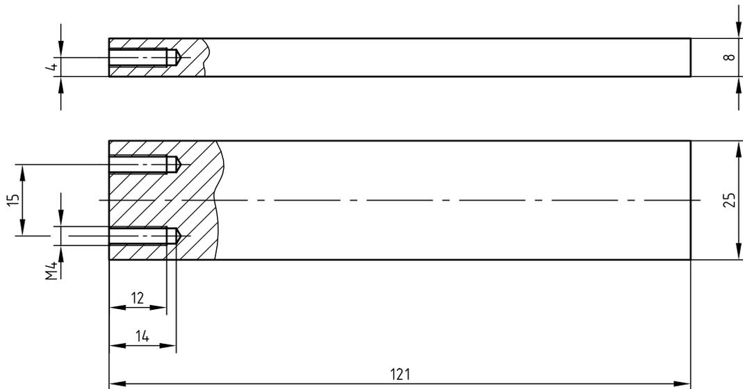
Die Befestigung der Führungsleiste auf der Montageplatte ist von Ihnen selbst auszuführen. Befestigungsschrauben sind zu versenken. Beachten Sie die Maßangaben in der Zusammenbauzeichnung.
