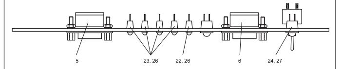
Maß "X" richtet sich nach den verwendeten Bauelementen. Die Positionsnummern beziehen sich auf die Seiten 4 und 5. Die Bauelemente in der Frontplatte dürfen montiert, jedoch **nicht** vorverdrahtet werden (Ausnahme: -A10.S1, siehe hierzu die Informationen in den Standard-Bereitstellungsunterlagen).
