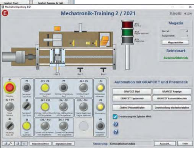
Ablauf der GRAFSET-Pläne überwachen und deren Funktionsweise verstehen
