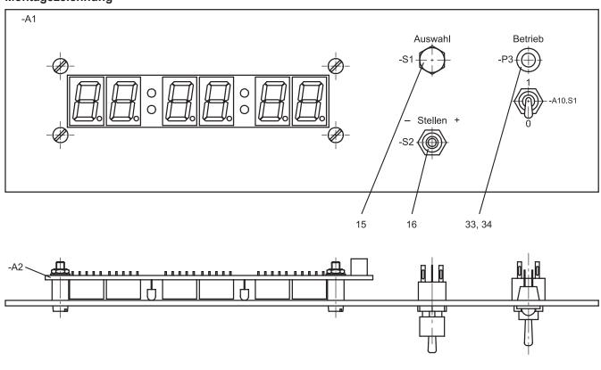
Die Positionsnummern beziehen sich auf die Seiten 4 bis 6. Die Maße "X" richten sich nach den verwendeten Bauelementen. Die Bauelemente in der Frontplatte dürfen **nicht** vorverdrahtet werden (Ausnahme: -A10.S1, siehe hierzu die Informationen in den Standard-Bereitstellungsunterlagen). Zeichnungen nicht maßstabsgerecht.
