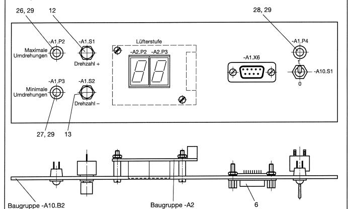
Maß "X" richtet sich nach den verwendeten Bauelementen. Die Positionsnummern beziehen sich auf die Seiten 4 und 5. Die Bauelemente in der Frontplatte dürfen montiert, jedoch **nicht** vorverdrahtet werden (Ausnahme: -A10.S1, siehe hierzu die Informationen in den Standard-Bereitstellungsunterlagen).
