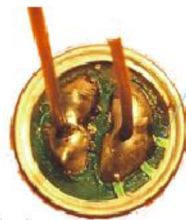
Mikrofon: Anschlüsse mittig einlöten
