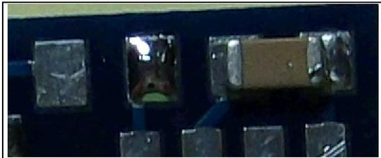
Bei der roten LED ist die Anode an der Unterseite mit einem dicken Balken gekennzeichnet. Die Anode zeigt im Bild nach rechts.
