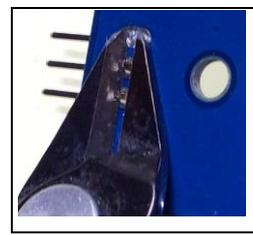
Die drei Pins der Stiftleiste werden nur oben verlötet und an der Unterseite bündig abgeschnitten. So kann die Platine später flach an den Roboter angeschraubt werden.
