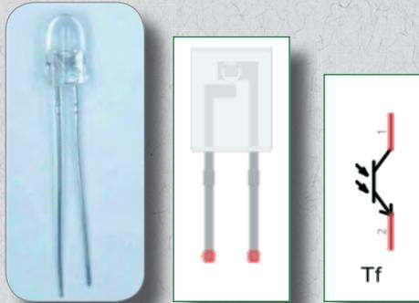
Abb. 2.17: Der Fototransistor und die zugehörigen Aufbau- und Schaltsymbole
