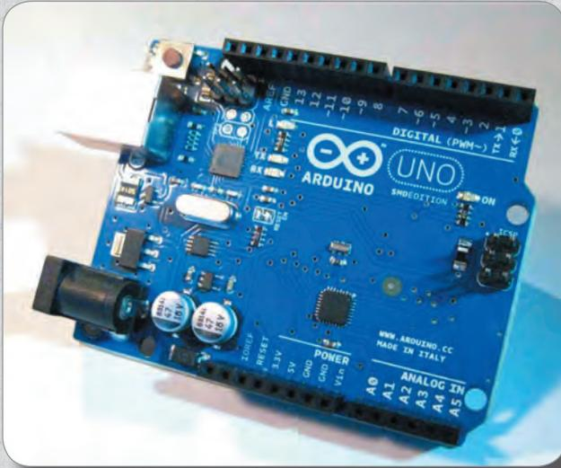
Abb. 0.1: Arduino UNO in der klassischen Bauform
